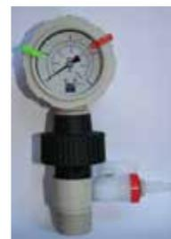
Датчик мембранного типа (код MM)
