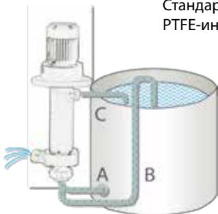
Всасывающий трубопровод может быть подсоединен непосредственно через стенки резервуара (А), или он может быть в виде сифонной трубы (В), как показано на чертеже. В случае использования закрытого клапана на выпускной трубе, переливная труба (С) снимает давление путем пропускания жидкости обратно в резервуар.
