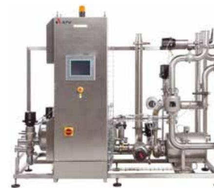
Линия для приемки молока включает в себя прием молока и других жидких молочных продуктов для дальнейшей обработки на молокоперерабатывающем заводе. Основная функция заключается в ликвидации воздуха, измерении количества, перекачивании и охлаждении перед хранением и дальнейшей обработкой.
