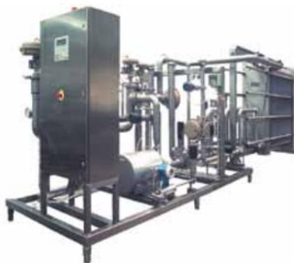
Диапазон возможных функций WortMaster включает: охлаждение сусла, дозация дрожжей, аерация сусла. Предназначенный для легкой интеграции с существующими линиями, WortMaster обеспечивает эффективное и точное дозирование дрожжей и кислорода с использованием инжектора APV (дозатора).
