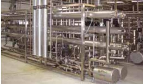
Мембранная фильтрация с применением спиральных и пластинчатых мембран для получения максимально возможного остатка сухих веществ. Мембранная технология – это испытанный метод разделения, осуществляемого на молекулярном и ионном уровнях. За сорок лет эта технология была адаптирована применительно для молочной промышленности. В молочной промышленности мембранная технология главным образом ассоциируется со следующими технологическими процессами:
