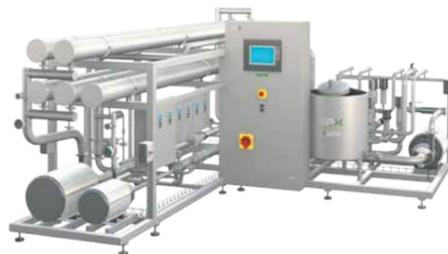
Системы APV FX SepStream — это конструируемые из готовых блоков и экономически эффективные мембранные системы для различных ситуаций применения в молочной промышленности. Системы APV FX SepStream отделяют и концентрируют обрабатываемую сыворотку или молоко для производства новых высокоценных основных продуктов или ингредиентов по безотходному принципу – полученную после производства воду можно использовать в других технологических процессах.
