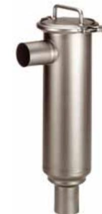
**Стандартная конструкция:** Фильтр изготовлен из кислотостойкой нержавеющей стали (AISI 316L). Внешняя обработка и внутреннее масштабирование, с фиксатором крышки для легкого удаления цилиндрической вставки фильтра. Фильтр доступен с размером ячеек 1, 2 или 3 мм. Материал стрейнера - нержавеющая сталь. Двойной фильтр комплектуется 4 клапанами-бабочками.
