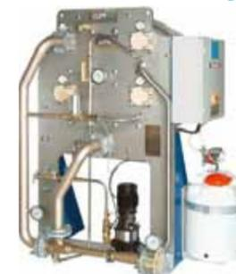
Система опреснения воды WDU (теплообменники со специально разработанными титановыми пластинами для эффективного прохождения пара и высокой производительности) установка для получения пресной воды при производстве питьевой и пресной технической воды, используется для установки на борту судов и буровых установок. Пластины: титан; прокладки: NBR; резервуар: AISI 316L; рама и водопровод для пресной воды: AISI 316L, водопровод для морской воды: CuNi (мельхиор).
