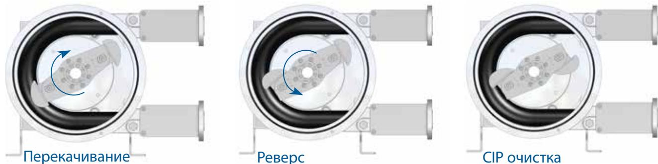
PT-насосам доступна опция "CIP-колесо" (Очистка без разборки), что позволяет пользователям просто изменить направление вращения насоса (поворот), чтобы можно было автоматически развернуть башмаки, чтобы реализовать процедуры очистки и стерилизации, не предпринимая каких либо специальных действий с насосом. Клиент экономит время и сохраняет высокий уровень функционирования процесса.
