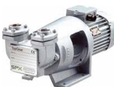
Серия шестеренных насосов Top Gear L & RBS, разработанная для эффективного перекачивания маловязких жидкостей, представлена 7 типоразмерами с номинальным диаметром патрубков от 30 мм до 44,5 мм, максимальной подачей до 84 л/мин и максимальным рабочим давлением до 25 бар. Максимально допустимые температура, динамическая вязкость перекачиваемой жидкости и размер твердых частиц в ней для насосов серии Top Gear L & RBS составляют соответственно 250 °C, 60000 мПас и 0,1 мм.
