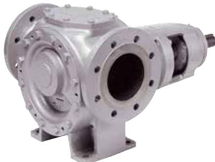
Серия шестеренных насосов общего назначения Top Gear G представлена 10 типоразмерами с номинальным диаметром патрубков от 25 мм до 150 мм, максимальной подачей до 130 м<sup>3</sup>/ч и максимальным рабочим давлением до 16 бар. Максимально допустимые температура, динамическая вязкость перекачиваемой жидкости и размер твердых частиц в ней для насосов серии Top Gear G составляют соответственно 300 °C, 80000 мПас и 0,225 мм.
