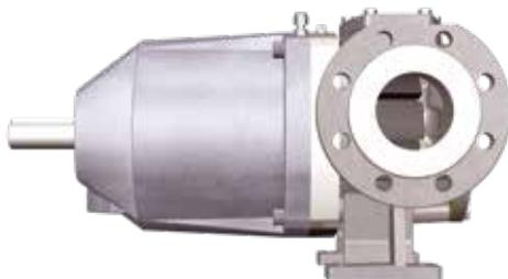
Серия шестеренных насосов Top Gear MAG, разработанная специально для перекачивания токсичных и взрывчатых веществ, представлена 5 типоразмерами с номинальным диаметром патрубков от 50 мм до 125 мм, максимальной подачей до 80 м<sup>3</sup>/ч и максимальным рабочим давлением до 16 бар. Максимально допустимые температура, динамическая вязкость перекачиваемой жидкости и размер твердых частиц в ней для насосов серии Top Gear MAG составляют соответственно 250 °C, 10000 мПас и 0,15 мм.
