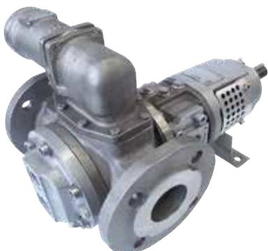
Серия шестеренных насосов Top Gear H, разработанная специально для особо ответственных применений, представлена 9 типоразмерами с номинальным диаметром патрубков от 32 мм до 150 мм, максимальной подачей до 130 м<sup>3</sup>/ч и максимальным рабочим давлением до 16 бар. Максимально допустимые температура, динамическая вязкость перекачиваемой жидкости и размер твердых частиц в ней для насосов серии Top Gear H составляют соответственно 300 °C, 80000 мПас и 0,225 мм.
