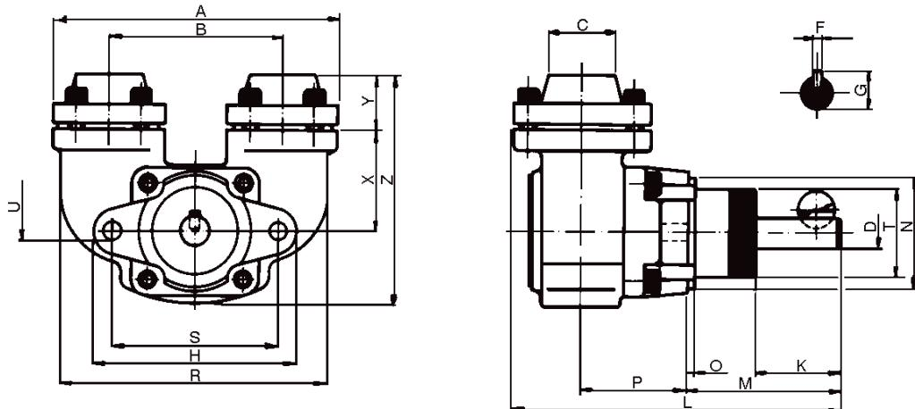
Насос с опорной стойкой для установки на лапах на опорной плите
