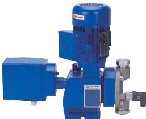
Традиционный мембранный насос для низких и средних требований с двойной мембраной с механическим приводом для экономичного использования надежной мембранный технологии. Рассчитаны на рабочее давление 20 бар и расход при дозировании до 3000 л/ч.
