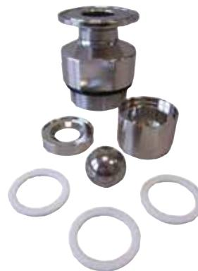
Хомутное соединение и шариковый клапан из нержавеющей стали марки SS316L с Ra <0,8μm, прокладка из PTFE (одобрен FDA)
