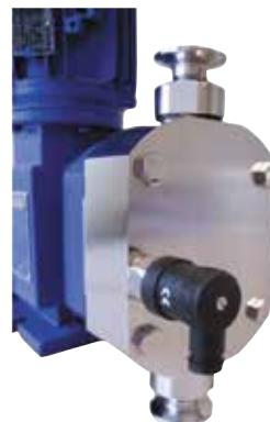
Электрополированная головка насоса с шероховатостью поверхности Ra <0,8 μm с датчиком давления для системы контроля мембранны
